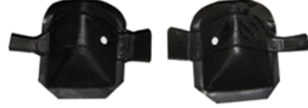
J9 ARKA DALLUMBAZ AMORTİSÖR YERİ SAĞ SOL (J9 absorbers in the rear right-left dallumbaz)
